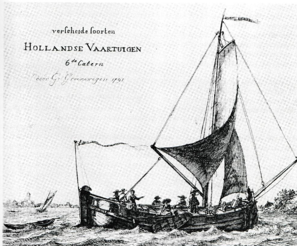
De poon of pont was in de achttiende eeuw in Holland een bekend scheepstype van 20 tot 60 ton dat gebruikt werd voor beurt- en vrachtvervoer. Een hiervan afgeleid schip was de turfpoon of turfeiker. Beide typen werden vooral in Gouda en omgeving gebouwd. (Tekening G. Groenewegen 1791; Nederlands Scheepvaartmuseum)
